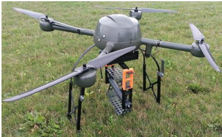
Obrázek 4 – Příklad dronu připraveného pro systém měření frekvenčního spektra.
