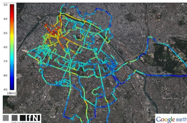
Obrázek 30: Přehled úrovně vstupního výkonu přijímače měřeného v terénní zkoušce v centrální a jihovýchodní části Paříže
