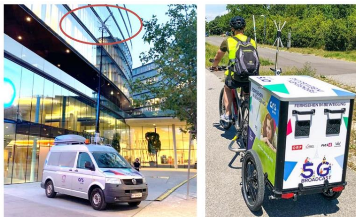
Obrázek 25: Vozidla pro stacionární měření a měření při vysokých a nízkých rychlostech pro 5G Broadcast.
